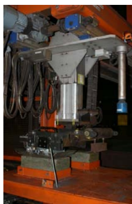
Fig 1 Récepteur Supermagnag (ArcelorMittal Gent): Mesurage on-line de la qualité de frittage
