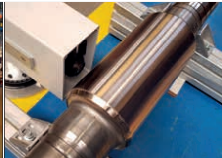
Fig. 2 : Cylindres lamineurs, produits dans la ligne pilote de galvanisation électrique, avec un revêtement nouveau en remplacement du revêtement CrVI
