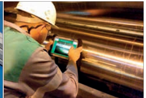
Fig. 3 : Outil intelligent pour l'évaluation des cylindres lamineurs
