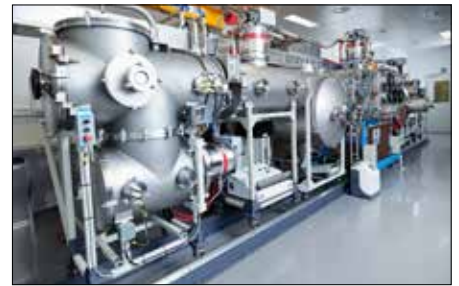
Ligne pilote 'Roll-to-Roll' pour la montée en échelle du revêtement des plaques bipolaires en acier inoxydable pour les piles à combustible
