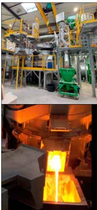
Fig. 1 – Four pilote plasma pour simulation EAF, SAF ou des routes de valorisation des scories
