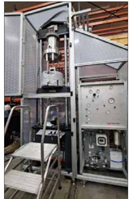
Fig. 4 – Testfaciliteiten voor materiaalgedrag bij blootstelling aan waterstof
